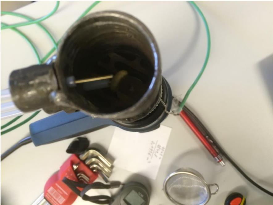
Abbildung 19: vermeintlich verbesserter Versuchsabbau durch eine am Thermoelement befestigte Kaffeebohne
