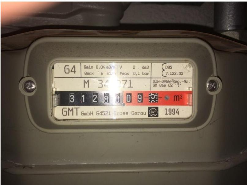
Abbildung 10: Erdgasmessuhr zur Ermittlung der zugeführten Energie
